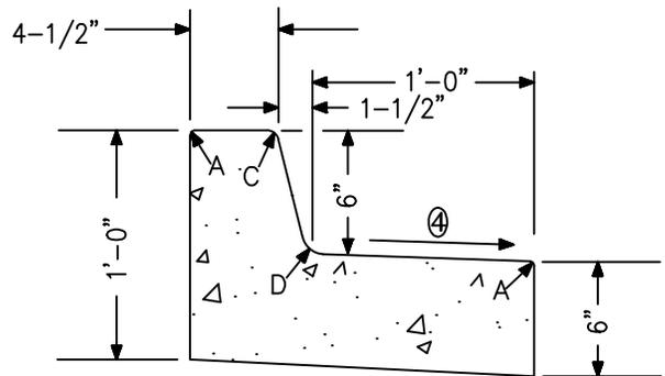
TYPE 2 CURB & GUTTER SECTION I B
