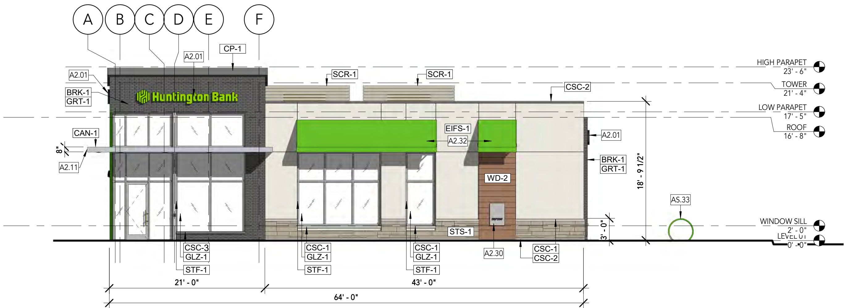
1 WEST ELEVATION SCALE: 1/8" = 1'-0"
